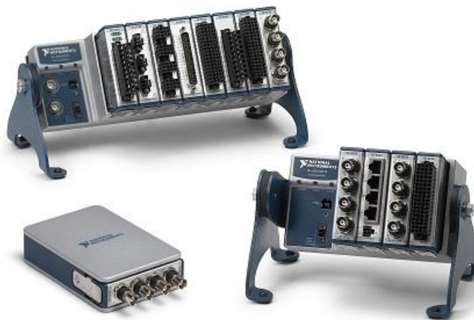
Obr. 13 Různá provedení systému CompactDAQ s měřicími kartami.[24]
