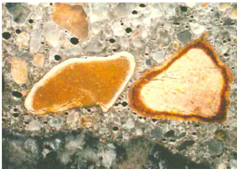
Obr. 2.15: Obklopené zrno alkalicko-křemičitým gelem [45].
