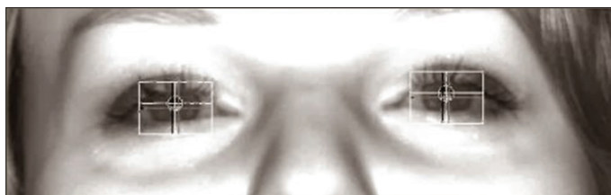
Obr. 14 Snímek z kamery umístěné na eye-trackeru. Bílým křížem je označen střed zornice, černým korneální odraz.
