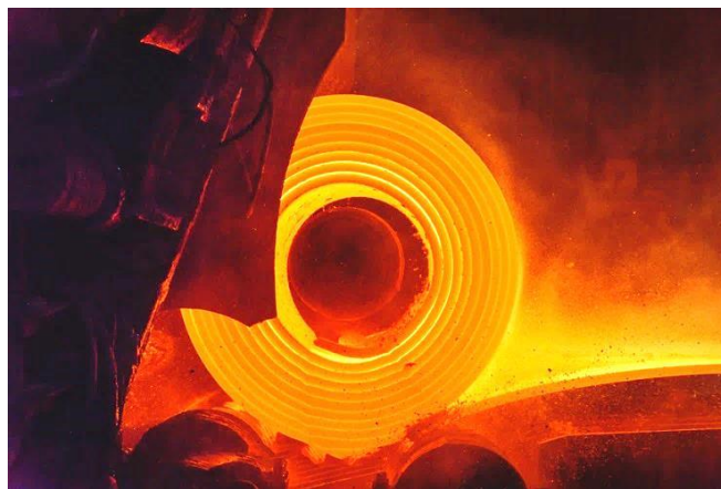
Obr. 6 Válcování svitku plechu za tepla [14]
