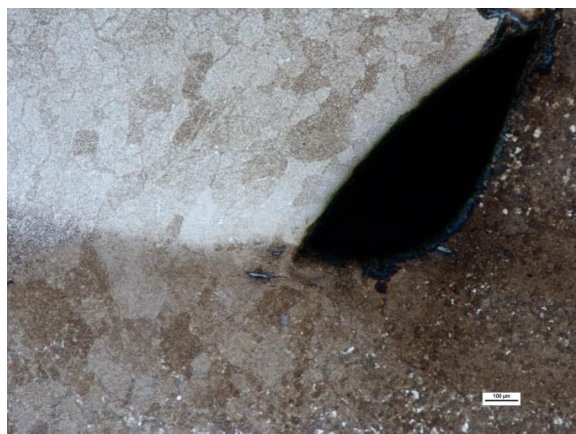
Obr. 63 Vady v dolních rozích vzorku č. 7 (SM 50x)
