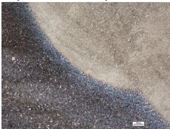
Obr. 53 Provaření rohů bez vad vzorku č. 5 (SM 50x)
