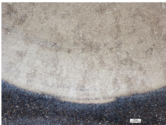
Obr. 54 Provaření kořene a mikrostruktura svarového kovu vzorku č. 5 (SM 50x, 500x)
