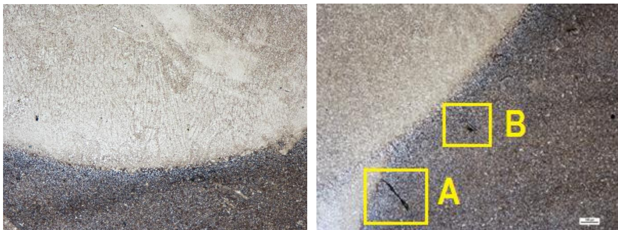
Obr. 57 Provaření kořene a rohu vzorku č. 6 (SM 50x)
