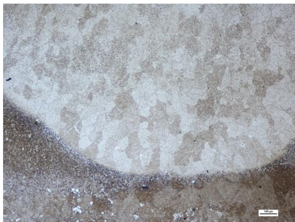
Obr. 63 Provaření kořene svaru vzorku č. 7 (SM 50x)
