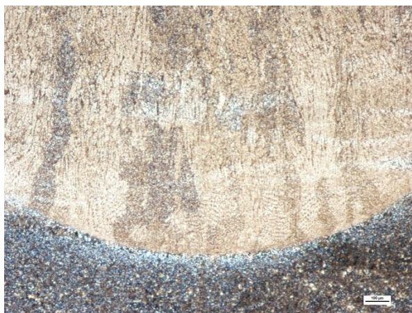
Obr. 73 Provaření kořene svaru (SM 50x)
