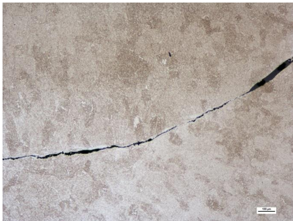
Obr. 64 Studený spoj ve svarovém kovu vzorku č. 7 (SM 50x)
