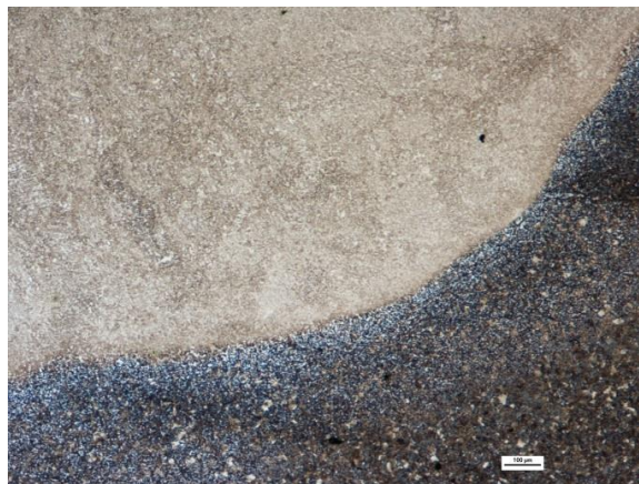
Obr. 53 Provaření rohů bez vad vzorku č. 5 (SM 50x)
