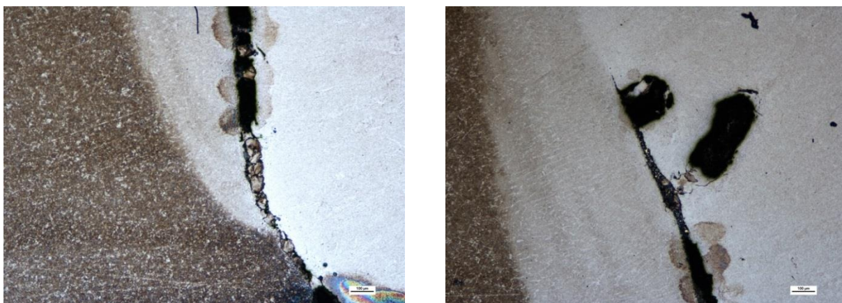
Obr. 49 Studený spoj od levého rohu vzorku č. 4 (SM 50x)
