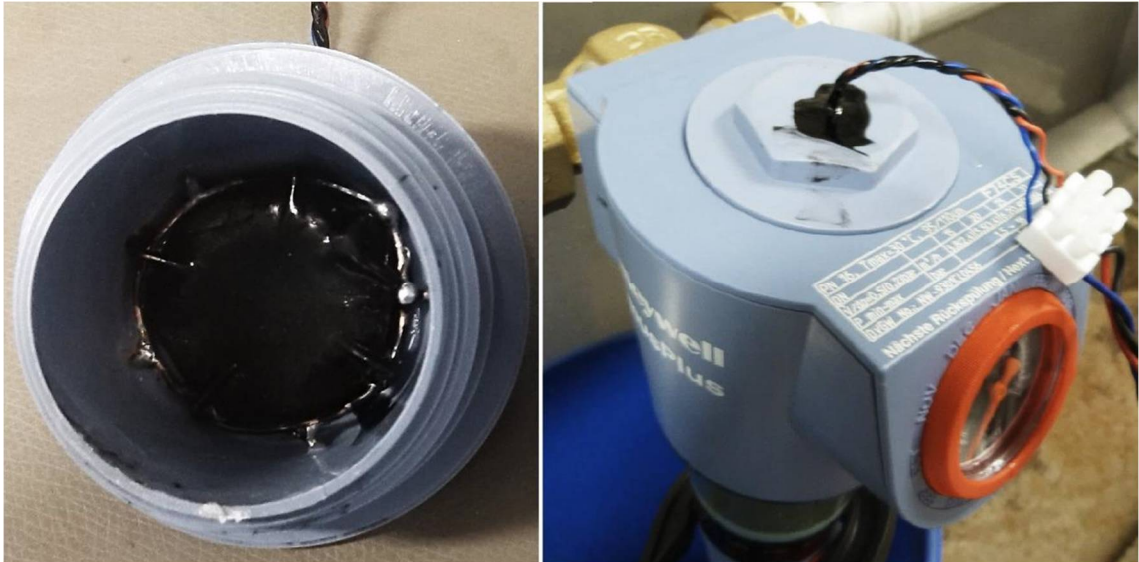
Obrázek 16.1: Piezoelektrický generátor – měnič zalitý v izolaci a vložený do víčka filtru (vlevo) a generátor instalovaný na filtru (vpravo)
