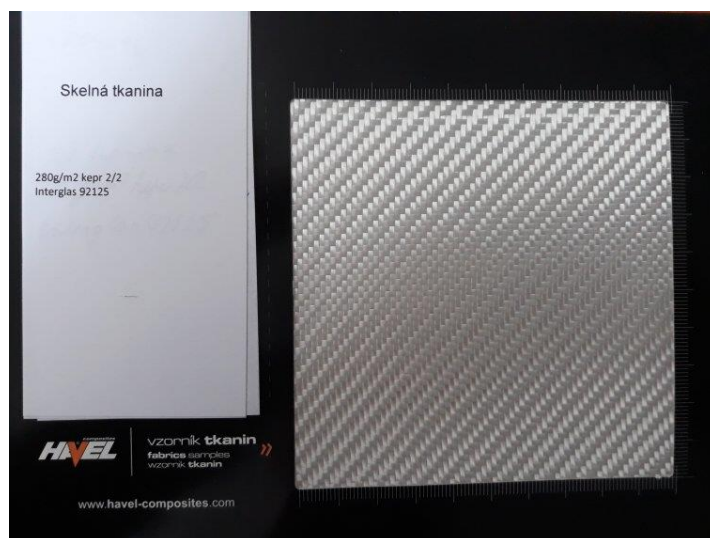
Obr. 2.8 Skelná tkanina 280 g/m 2 v keprové vazbě [22]
