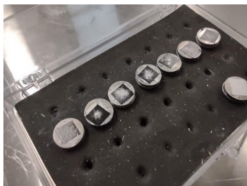
Obr. 3.20 Terče do SEM se vzorky
