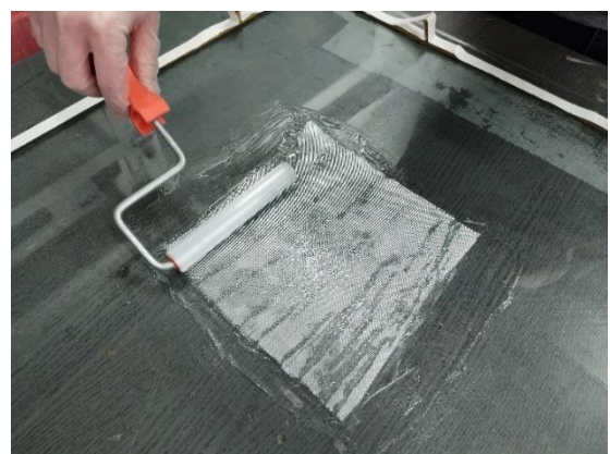
Obr. 3.6 Prosycování pomocí válečku
