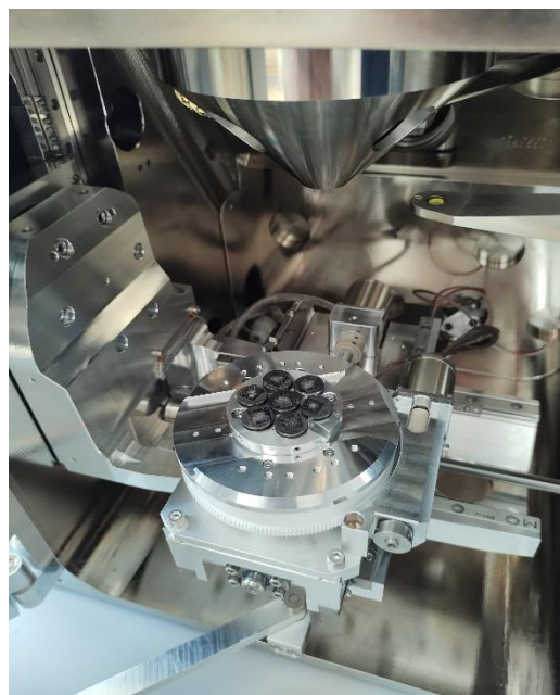
Obr. 3.21 Vkládání terčů do konzole SEM
