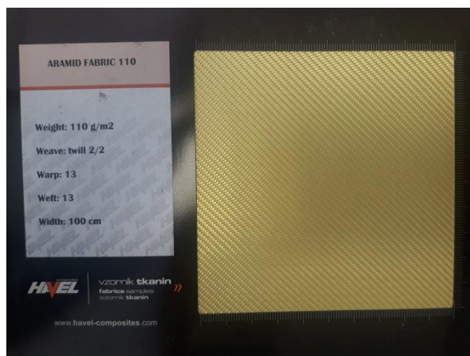
Obr. 2.7 Aramidová tkanina 110 g/m 2 v keprové vazbě [22]
