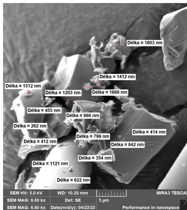
Obr. 4.38 Snímek vzorku vrtání (9,8; 1000) zachycený na SEM a následným analyzováním délek vlákněných částic pomocí softwaru NIS – ELEMENTS AR
