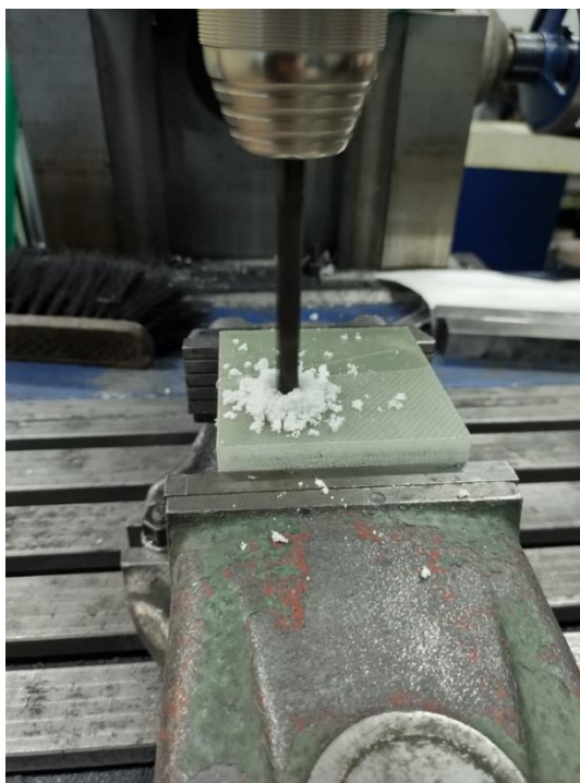
Obr. 3.18 Vrtání kompozitního vzorku
