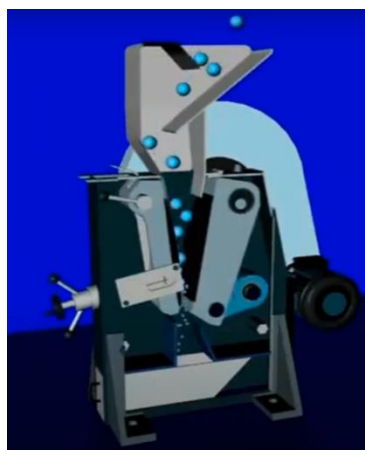
Obrázek 3.17 Princip čelistového drtiče [40]
