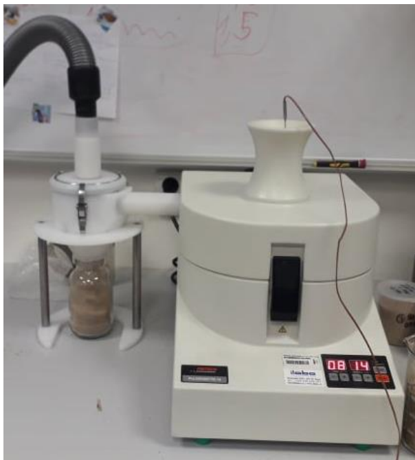
Obrázek 5.57 Zapojení mlýnu s cyklónem
