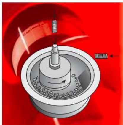
Obrázek 3.11 Princip hmoždířového mlýnu [32]
