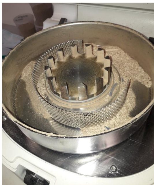
Obrázek 5.22 Roztržené síto a těsnění
