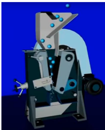
Obrázek 3.17 Princip čelistového drtiče [40]
