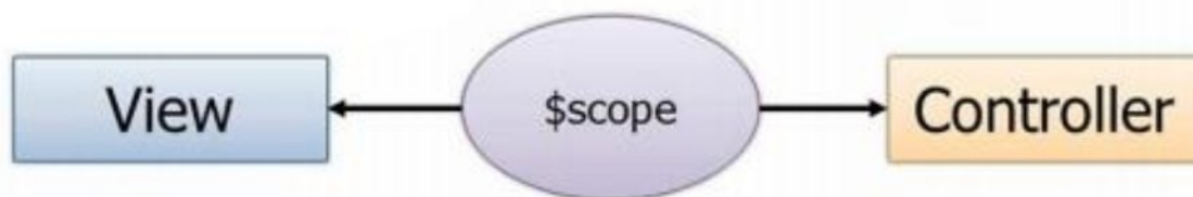
Obr. 3 Komunikace mezi View, Scopem a Controllerem v Angularu.
