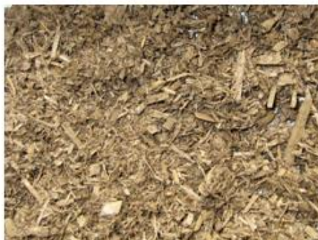
Obrázek 3.1 Separát z bioplynové stanice (Foto: Káňa, 2013)
