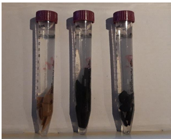
Obrázek 5.11 Rozpustnost ve studené vodě – nebělená buničina 65 SR, plošná hmotnost 400 g·m -2
