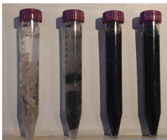
Obrázek 5.15 Rozpuštnost ve studené vodě – nasávaná kartonáž, plošná hmotnost 400 g·m -2
