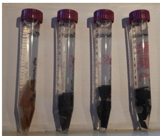
Obrázek 5.2 Rozpustnost ve studené vodě – nebělená buničina 20 SR, plošná hmotnost 200 g·m -2
