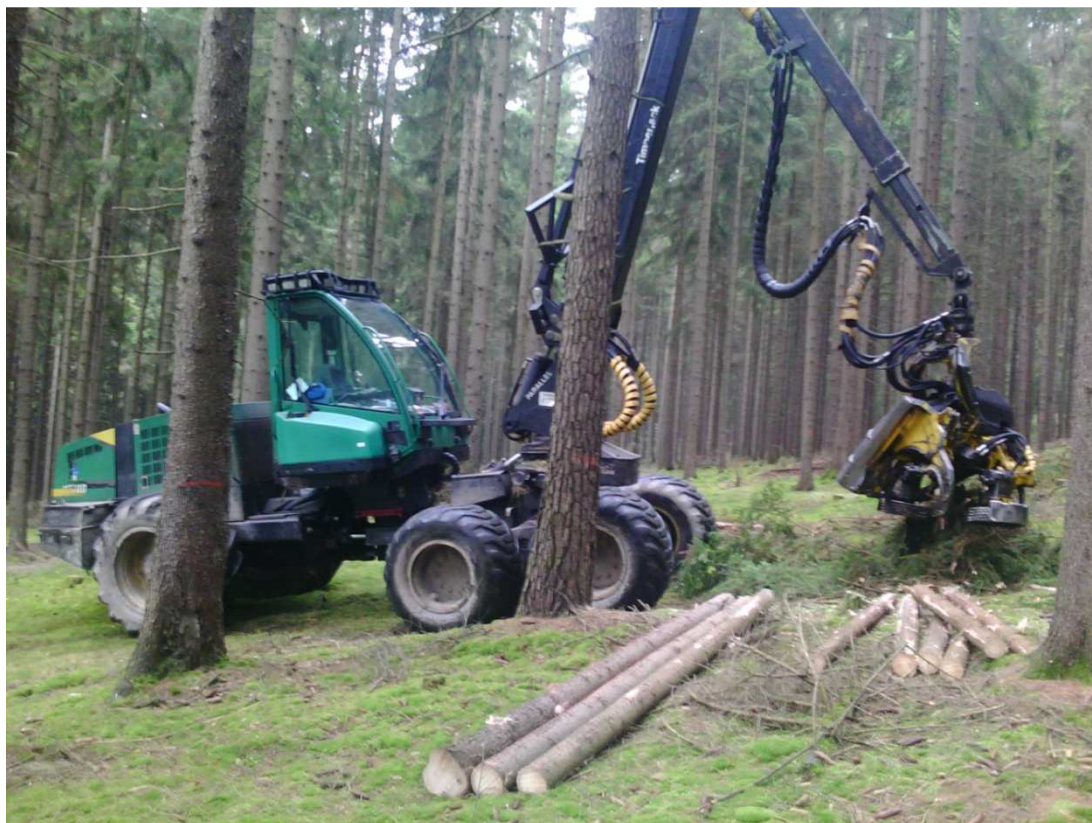
Obr. 16: Harvestorová technologie v probírce
