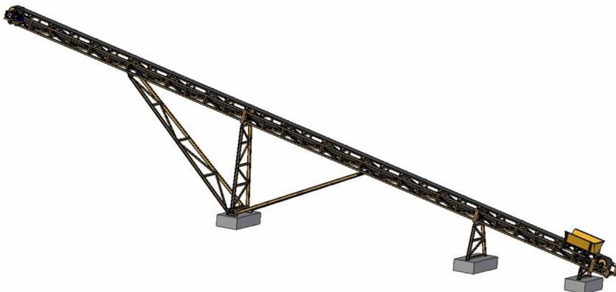
Obr. 28 Zkonstruovaný pásový dopravník
