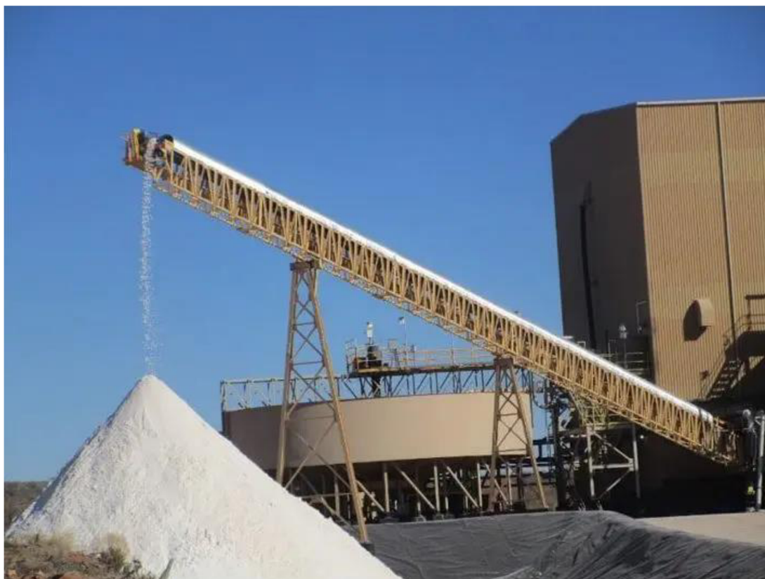
Obr. 3 Stabilní nosná konstrukce [22]
