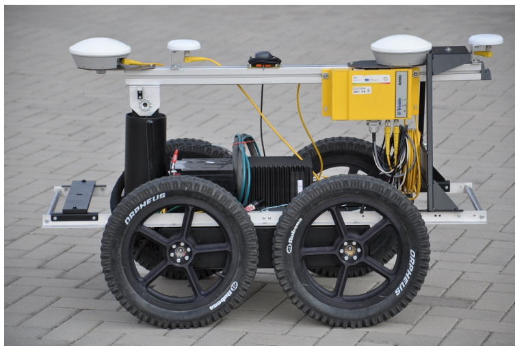
Obr. 8.13: Mobilní robot Orpheus-X3 upravený pro experimenty
