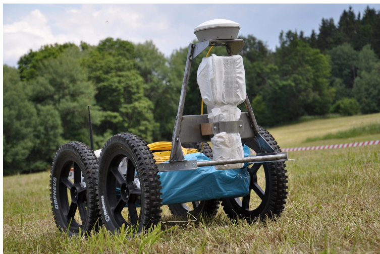
Obr. 8.5: Orpheus-X3 upravený pro měření gama záření – pohled zepředu
