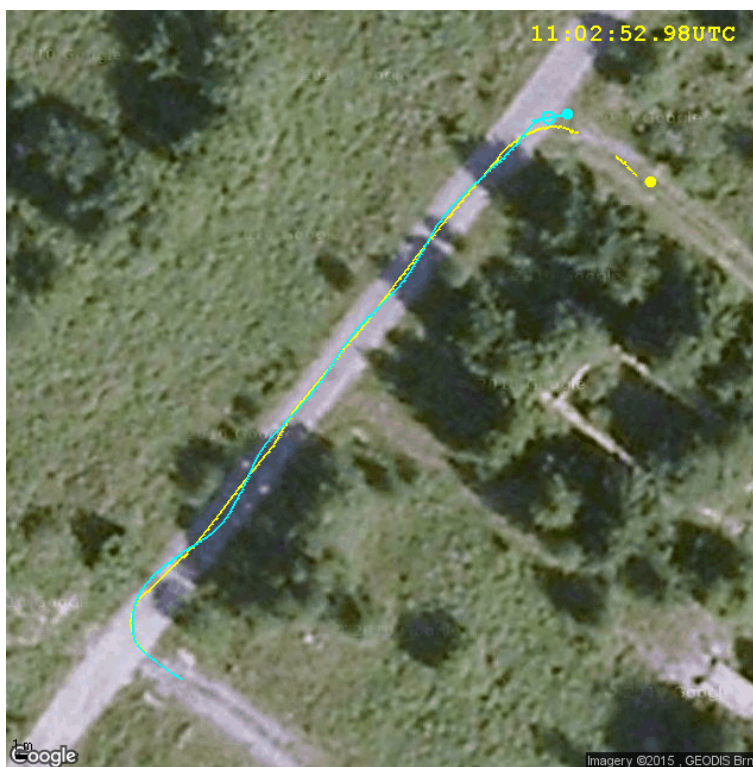
Obr. 8.23: Trajektorie (žlutá) vedoucího robotu (Orpheus-X3) konvoje a trajektorie (modrá) druhého robotu (Taros 6x6 V2) v konvoji
