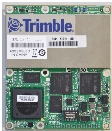
Obr. 7.3: Fotografie GNSS přijímače Trimble BD982
