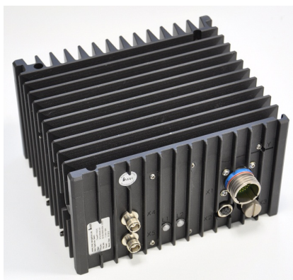
Obr. 7.2: Fotografie GNSS/INS systému iMAR iTraceRT-F400E
