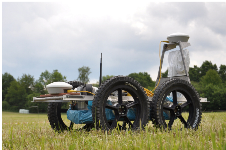
Obr. 8.6: Orpheus-X3 upravený pro měření gama záření – pohled zezadu
