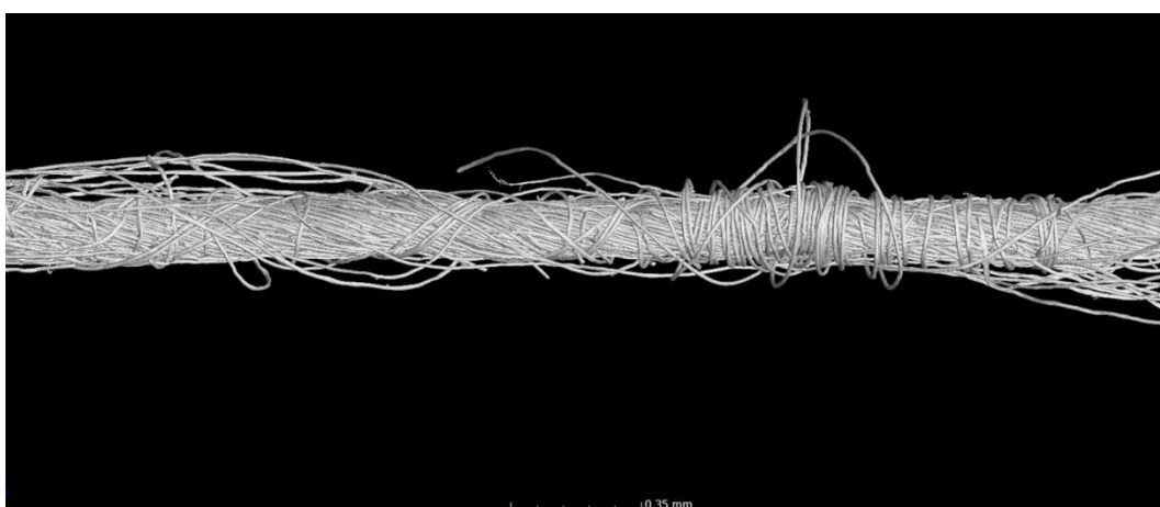
Obrázek 12 Detail rotorové příze [vlastní zdroj]
