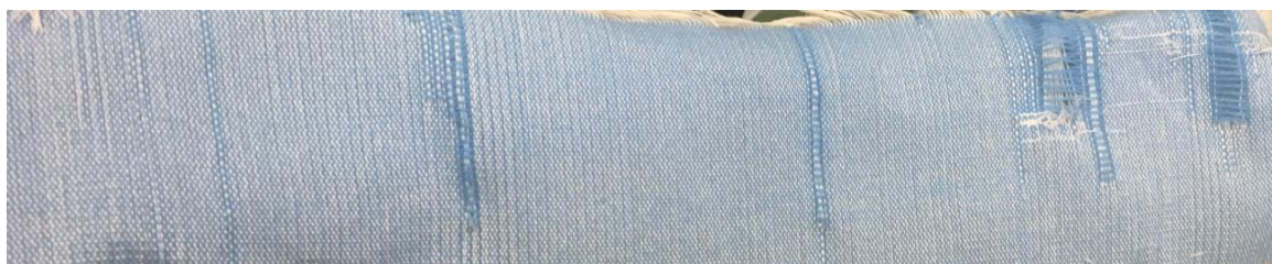
Obrázek 14 Detail defektů ve tkanině [vlastní zdroj]
