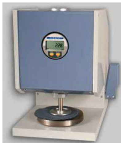
Obrázek 6 Tloušťkoměr firmy Mesdan [16]
