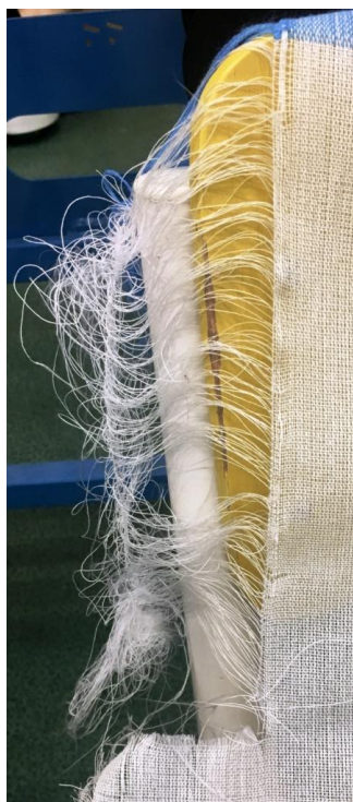
Obrázek 16 Detail rozsypaného kraje [vlastní zdroj]
