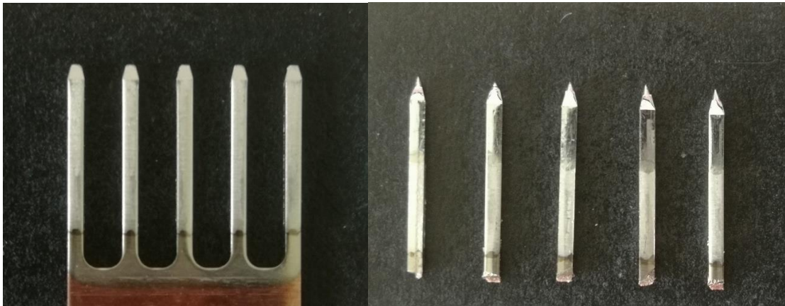
Obrázek 4.2 Testované piny 9612 před a po měření
