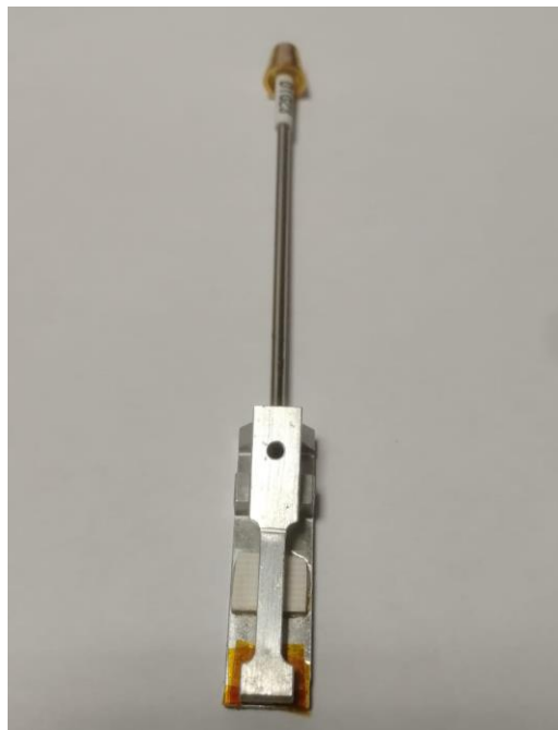
Obrázek 4.18 Doplnění izolační vrstvy na hliníkovou hlavici
