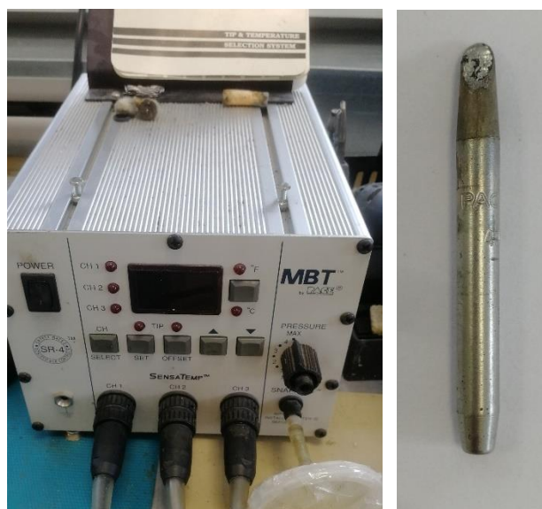
Obrázek 4.30 Pájecí stanice a použitý hrot
