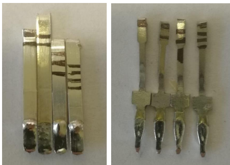
Obrázek 4.12 Testované piny 9624Big a 9624press po měření
