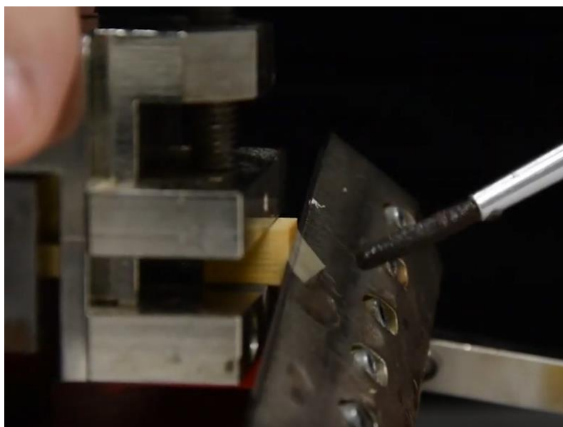
Obr. 9: Krájení vzorku pomocí sáňkového mikrotomu (detail)
