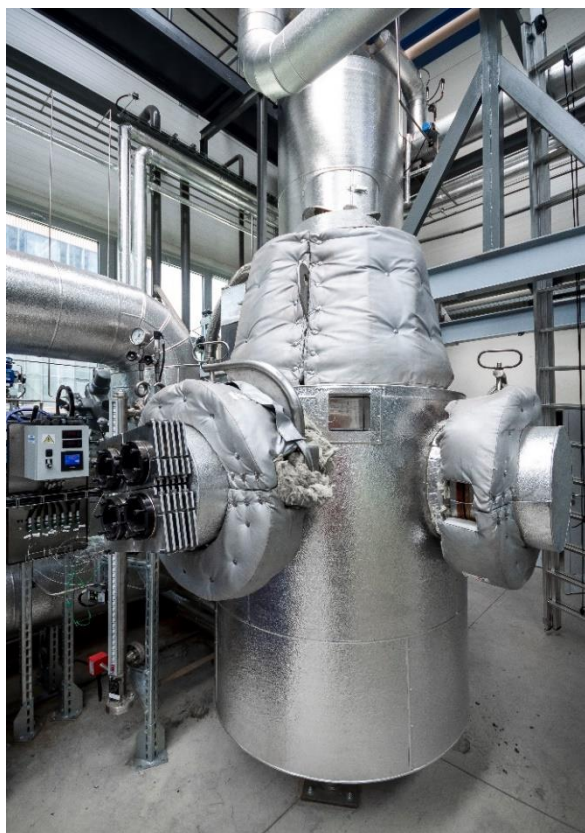
Obr. 1 Testovacia komora Malá LOCA [6]
