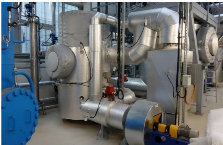
Obr. 2 Komora simulácie výbuchu H 2 [1]
