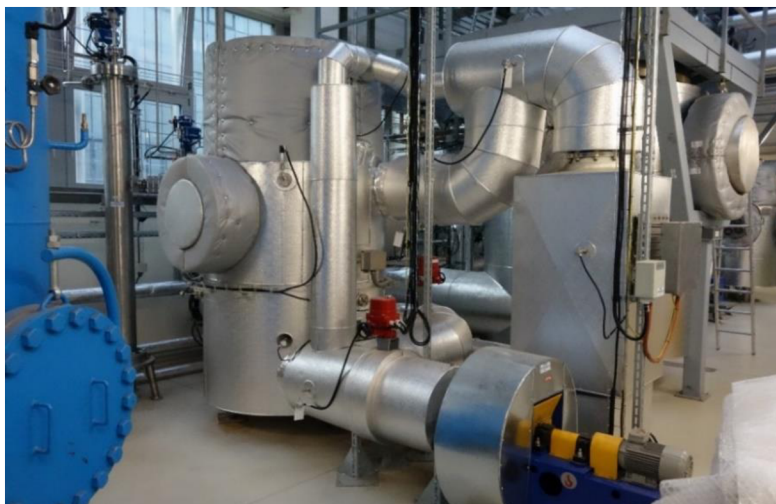
Obr. 2 Komora simulácie výbuchu H 2 [1]
