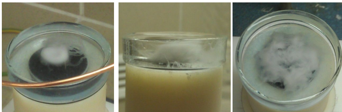
Obr. 32: Tvorba nanovláčenné 3D vrstvy s pomocí usměrňovače, tři různé vzorky v detailu. Zleva: 5c, 7c, 9c.
