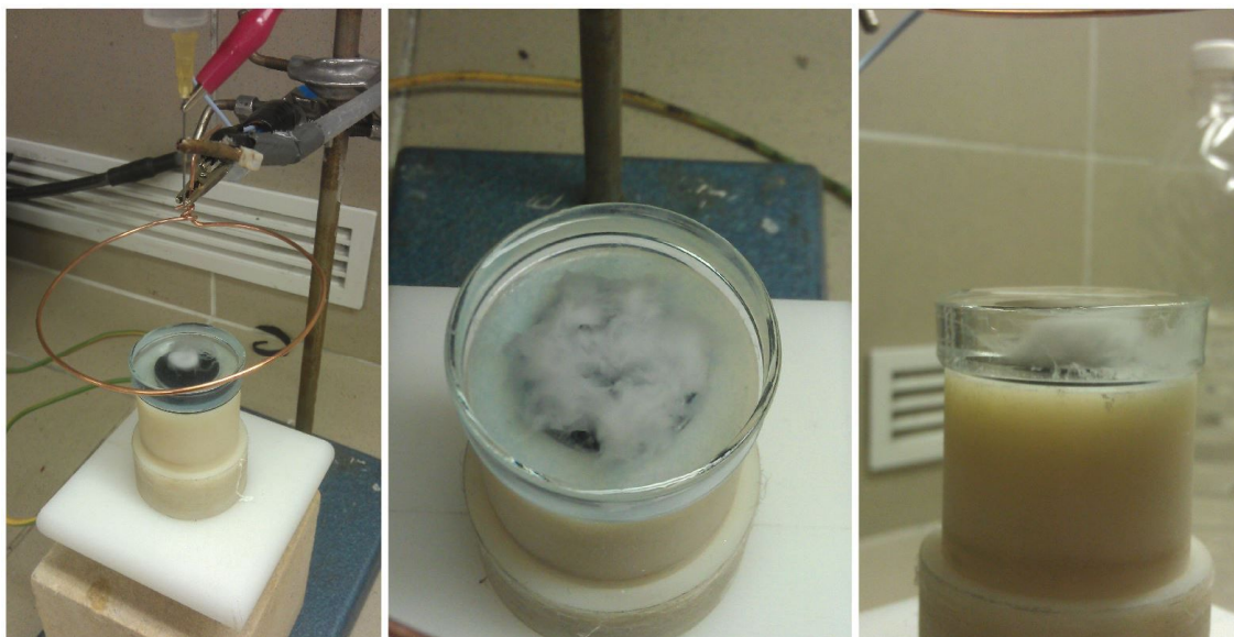
Obr. 24: Průběh elektrostatického zvlákňování do skleněného bazénku s použitím usměrňovacího vodiče.
