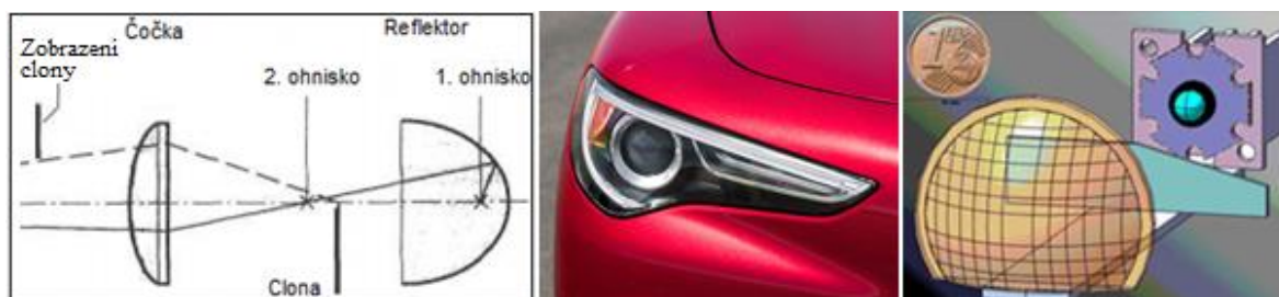
Obrázek 13 Schéma projekčního světlometu (vlevo), Bixenonový (25 watt) projekční světlomet Alfa Romeo Stelvio (uprostřed) a projekční systém LED světlometu (vpravo) [12], [55], [80]
