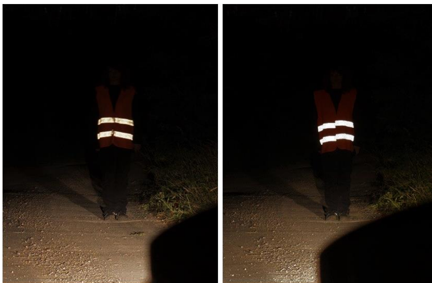
Obrázek 61 Vlevo: sepraná reflexní vesta (33 metrů před vozidlem), vpravo: nová vesta (33,5 metrů před vozidlem) při naměřených stejných intenzitách osvětlení (8 luxů v oblasti kotníků, 2 luxy v oblasti kolen)
