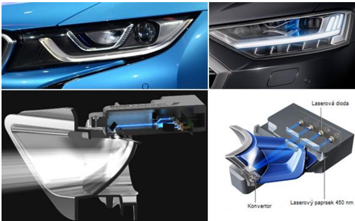
Obrázek 15 Světlomet BMW i8 (vlevo nahoře) a konstrukce jeho laserového světlometu (vlevo dole), světlomet Audi A8 (vpravo) a laserový systém v Audi (vpravo dole) [60], [61], [84], [85]
