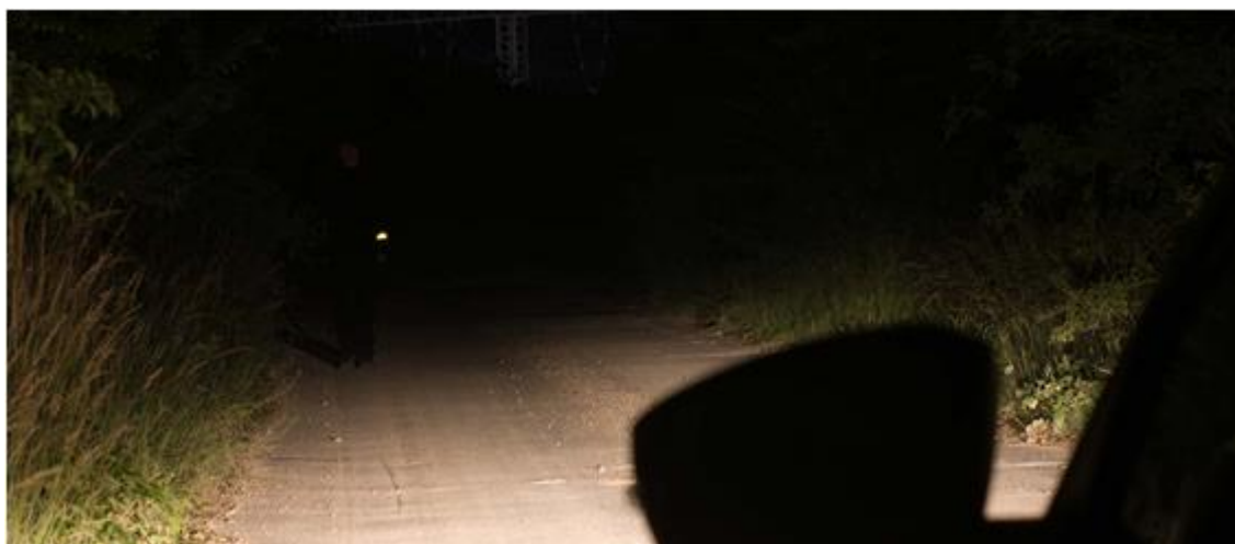
Obrázek 55 Černý figurant s reflexní páskou na zápěstí na levé straně vozovky rozpoznáný 6. řidičem na vzdálenost 31,5 metrů
