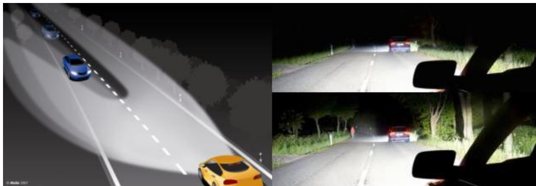
Obrázek 19 Neoslňující dálkový světlomet, vpravo nahoře jsou rozsvíceny světlomety bez neoslňující funkce, vpravo dole jsou rozsvíceny neoslňující dálkové světlomety, které výrazně lépe osvětlují chodce vlevo [20]
