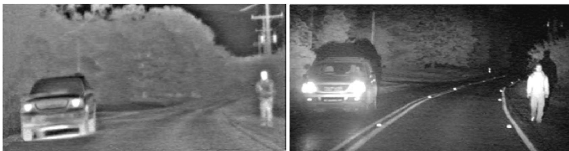
Obrázek 22 Systém FIR (vlevo) a systém NIR (vpravo) [111]
