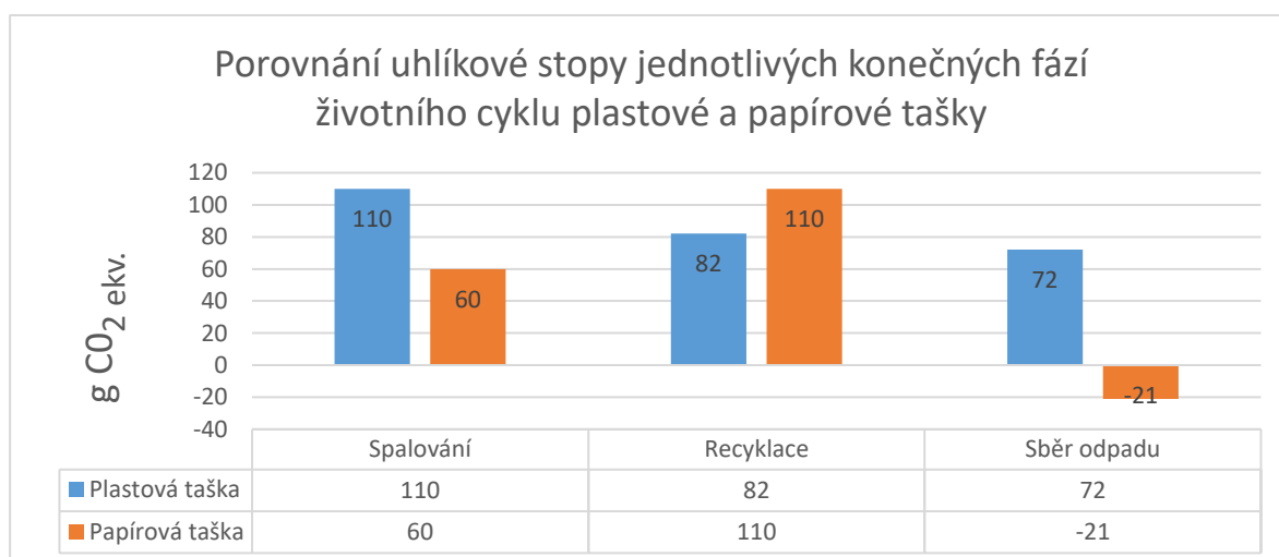
Obrázek 24 Porovnání uhlíkové stopy jednotlivých konečných fází životního cyklu plastové a papírové tašky.
