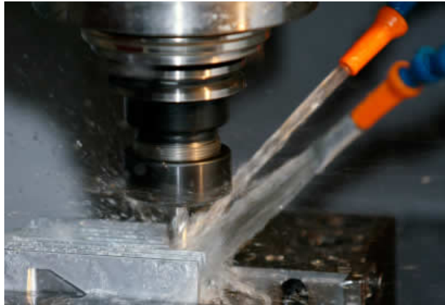
Obr. 2.1 Chlazení emulzní kapalinou při frézování 17
