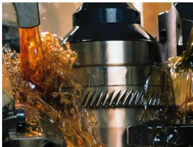
Obr. 2.2 Velkoobjemové chlazení olejem při odvalovacím frézování 11
