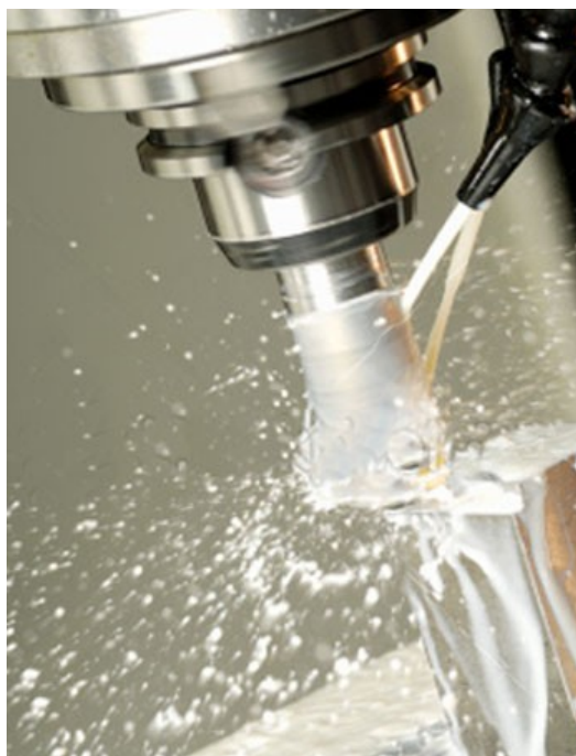
Obr. 2.4 Frézování s použitím syntetické procesní kapaliny 12
