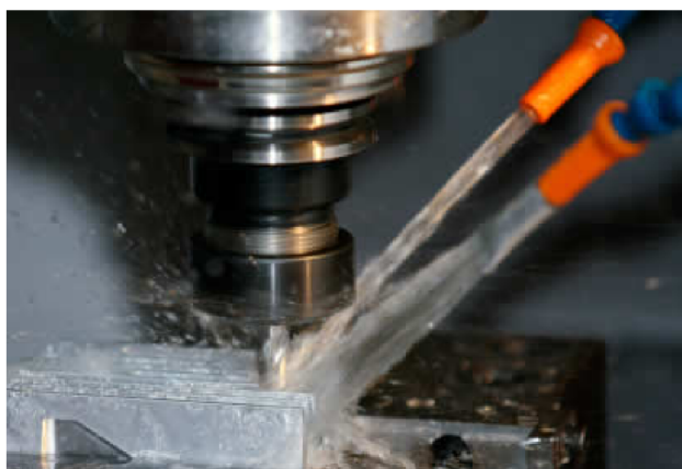
Obr. 2.1 Chlazení emulzní kapalinou při frézování 17
