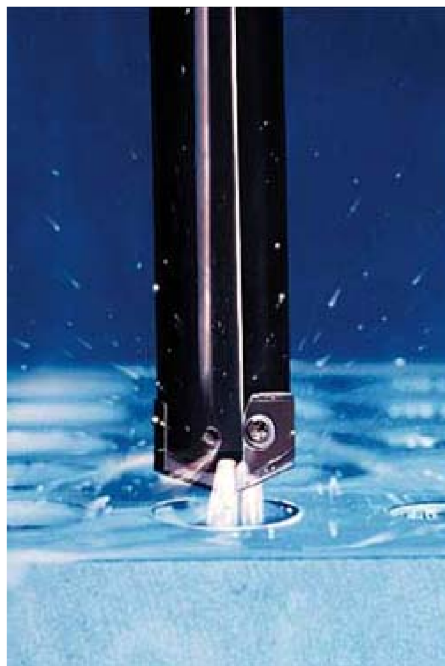
Obr. 4.3 Vnitřní chlazení při hlubokém vrtání 13
