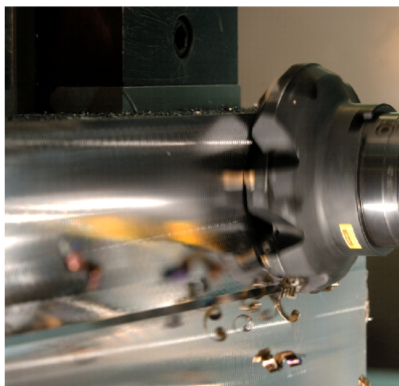
Obr. 8.2 Frézování za sucha 15
