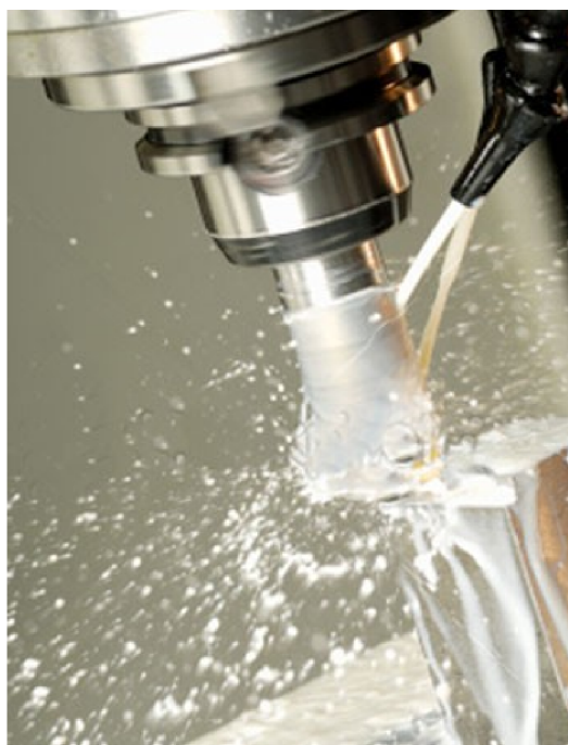
Obr. 2.4 Frézování s použitím syntetické procesní kapaliny 12
