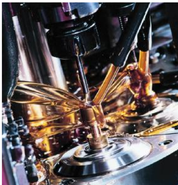
Obr. 2.3 Vrtání při chlazení olejem 12
