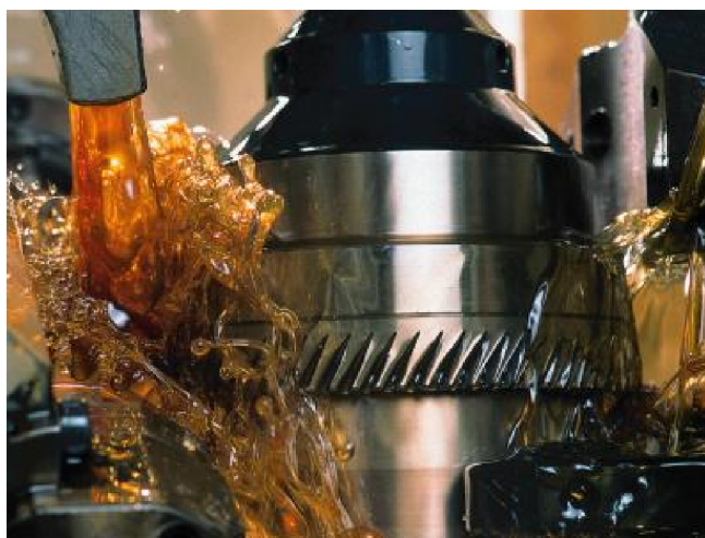
Obr. 2.2 Velkoobjemové chlazení olejem při odvalovacím frézování 11
