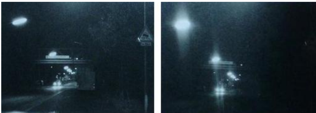
Obrázok 18 - Podmienky viditeľnosti cez prieszory poškodené škrabancami Zdroj (7)
