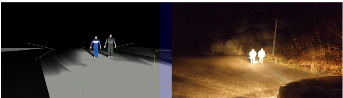
Obrázok 58 - Tmavý model, diaľkové H7, vzdialenosť 10 m Zdroj (vlastný)
