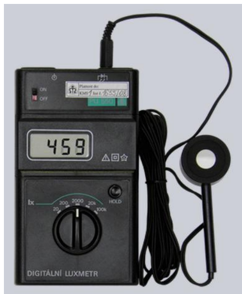
Obrázok 19 - Lux meter PU 550 Zdroj (16)
