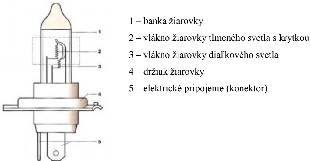
Obrázok 9 - Konštrukcia halogénovej žiarovky Zdroj (18)
