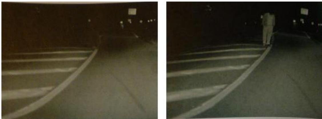
Obrázok 16 - Tmavo a svetlo oblečená osoba vo vzdialenosti 20 m od vozidla Zdroj (7)
