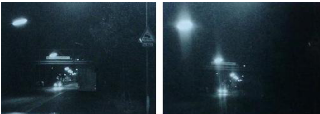
Obrázok 18 - Podmienky viditeľnosti cez priezory poškodené škrabancami Zdroj (7)
