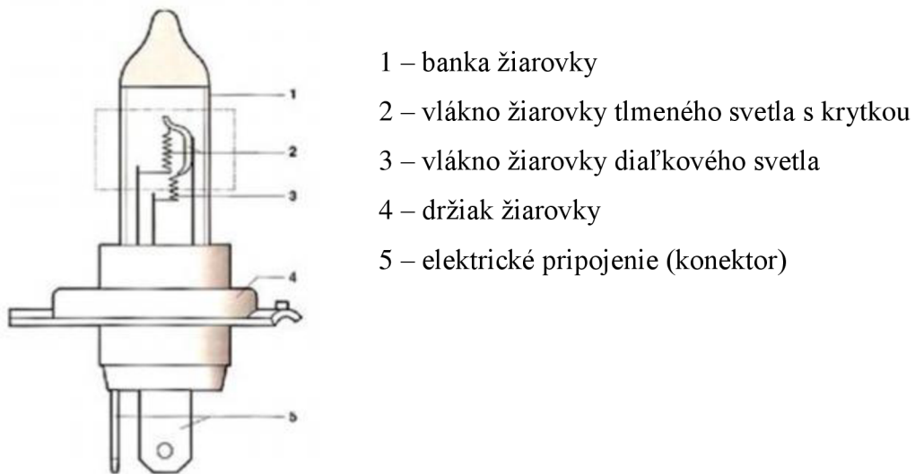
Obrázok 9 - Konštrukcia halogénovej žiarovky Zdroj (18)
