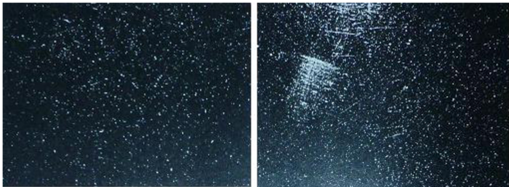
Obrázok 17 - Rozptýlené svetelné obrazy na poškodených čelných sklách Zdroj (7)
