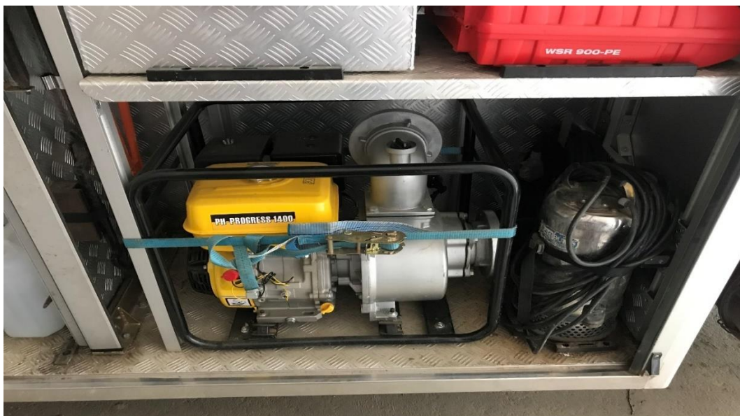
Obrázek 8: Kalové čerpadlo a elektro čerpadlo
