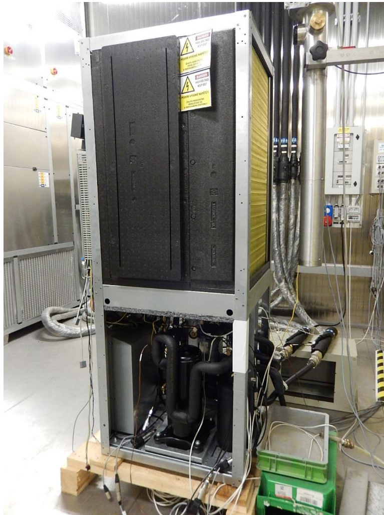
Obr. 23 TČ bez opláštění umístěné v klimakomoře
