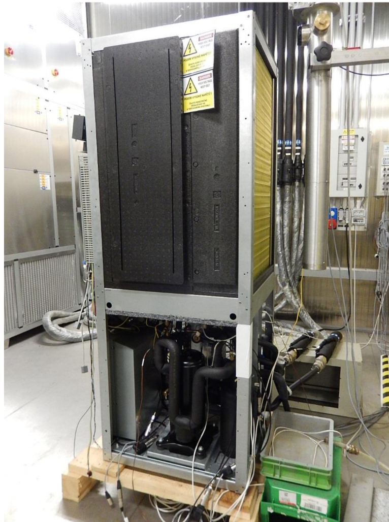
Obr. 23 TČ bez opláštění umístěné v klimakomoře
