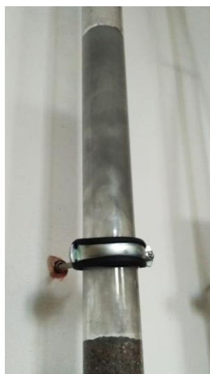
Obr. 8.24 Nanoželezo uvolňované z DORSILITU při zpětném praní
