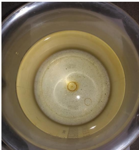
Obr. 8.27 Pohled na dno kádinky po 3 hod sedimentace
