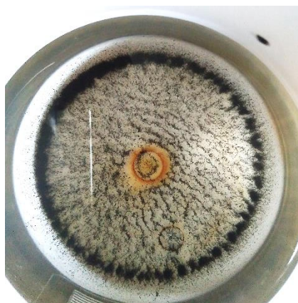
Obr. 8.20 Pohled do kádinky s usazenými vločkami
