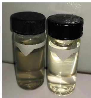
Obr. 8.22 Srovnání zákalu (vlevo modelová voda vedená na kolonu, vpravo filtrát – CFH 0818)
