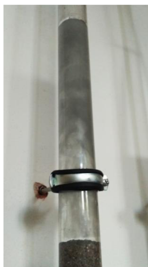
Obr. 8.24 Nanoželezo uvolňované z DORSILITU při zpětném praní
