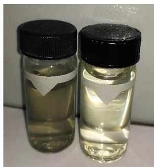
Obr. 8.22 Srovnání zákalu (vlevo modelová voda vedená na kolonu, vpravo filtrát – CFH 0818)
