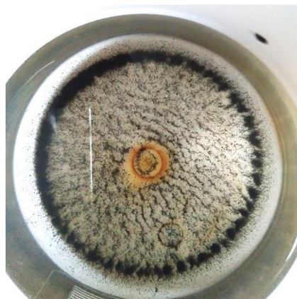
Obr. 8.20 Pohled do kádinky s usazenými vločkami
