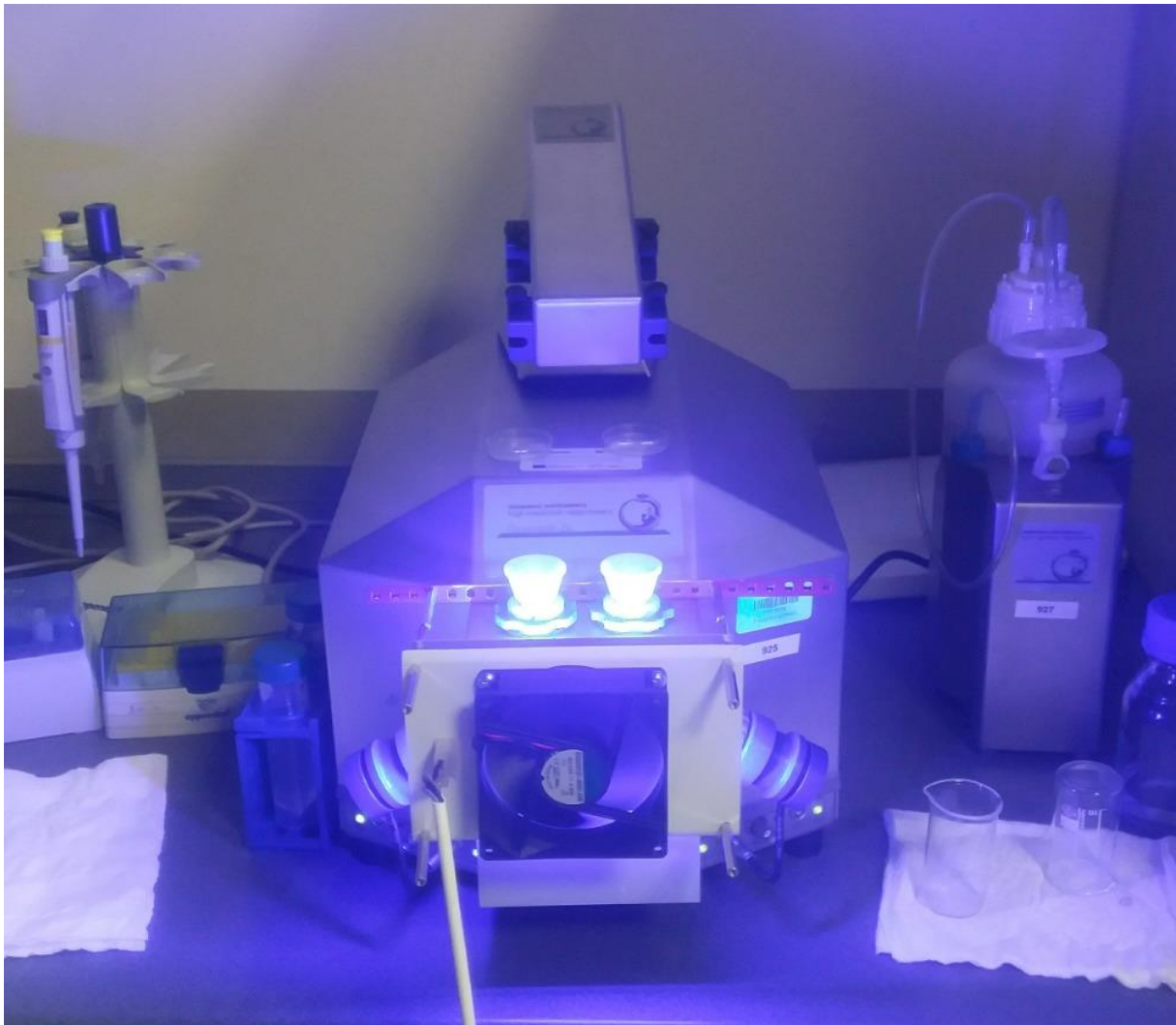
Obrázek 19: Měření buněčné respirace pomocí oxygrafu Oxygraph2k
