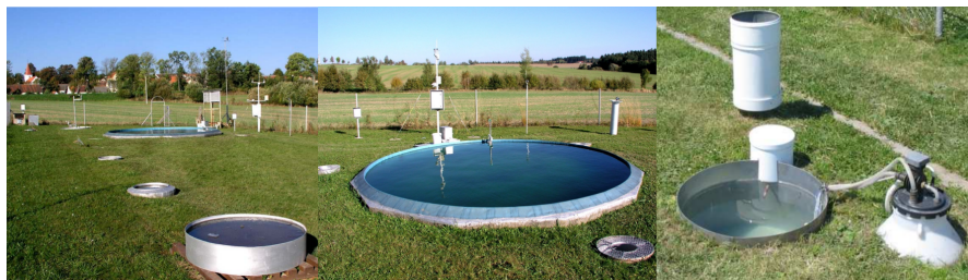
Obr. 3.4 Výparoměrná stanice Hlasivo: CGI 3000 (vlevo), srovnávací výparoměr (uprostřed), výparoměr EWM (vpravo) Šuhájková et al. (2020) .
