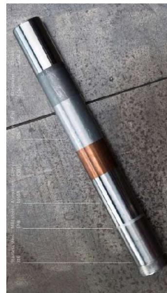
Obr. 29 Svařitelnost rozdílných kovů na strojích KUKA [44].
