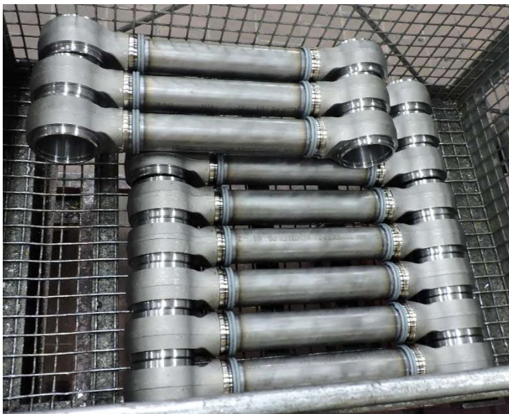
Obr. 28 Táhlo po svaření.
