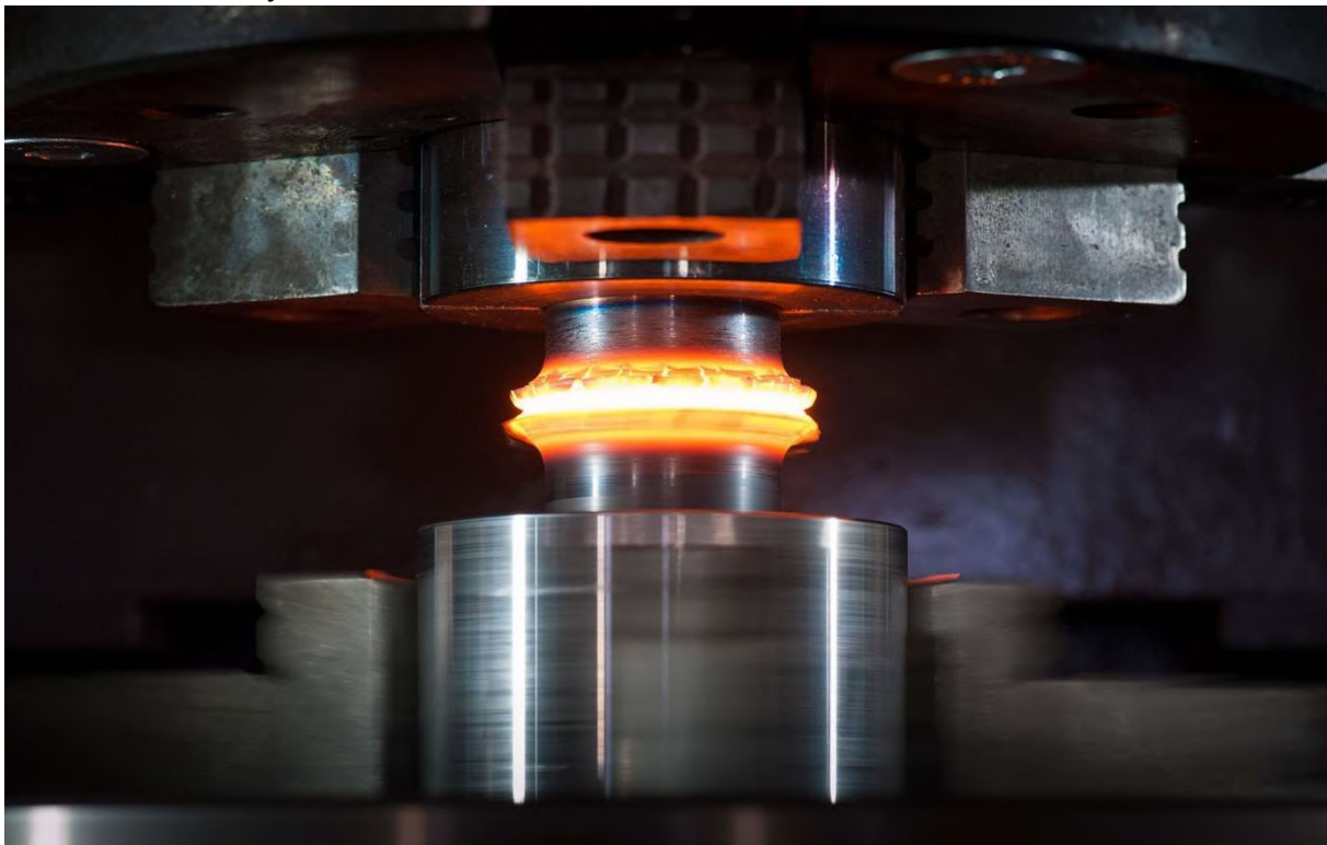
Obr. 1 Ukázka třecího svařování [9].
