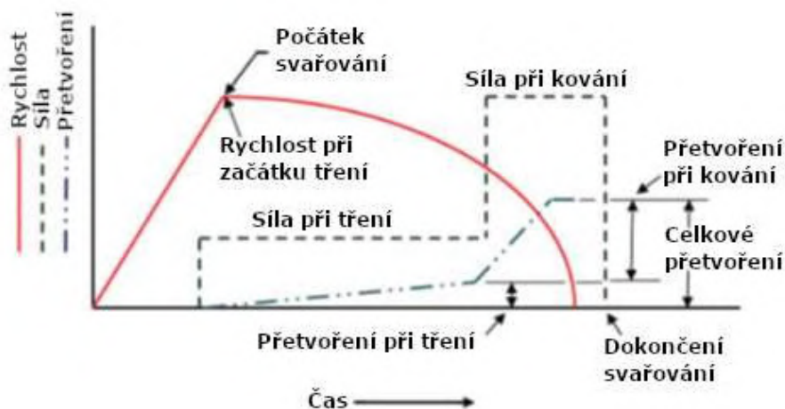
Obr. 16 Průběh rychlosti součásti, tvářecí síly a deformace při svařování pomocí setrvačnicku [10].
