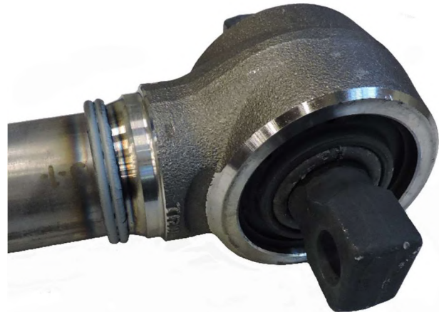
Obr. 11 Táhlo s nalisovaným čepem.
