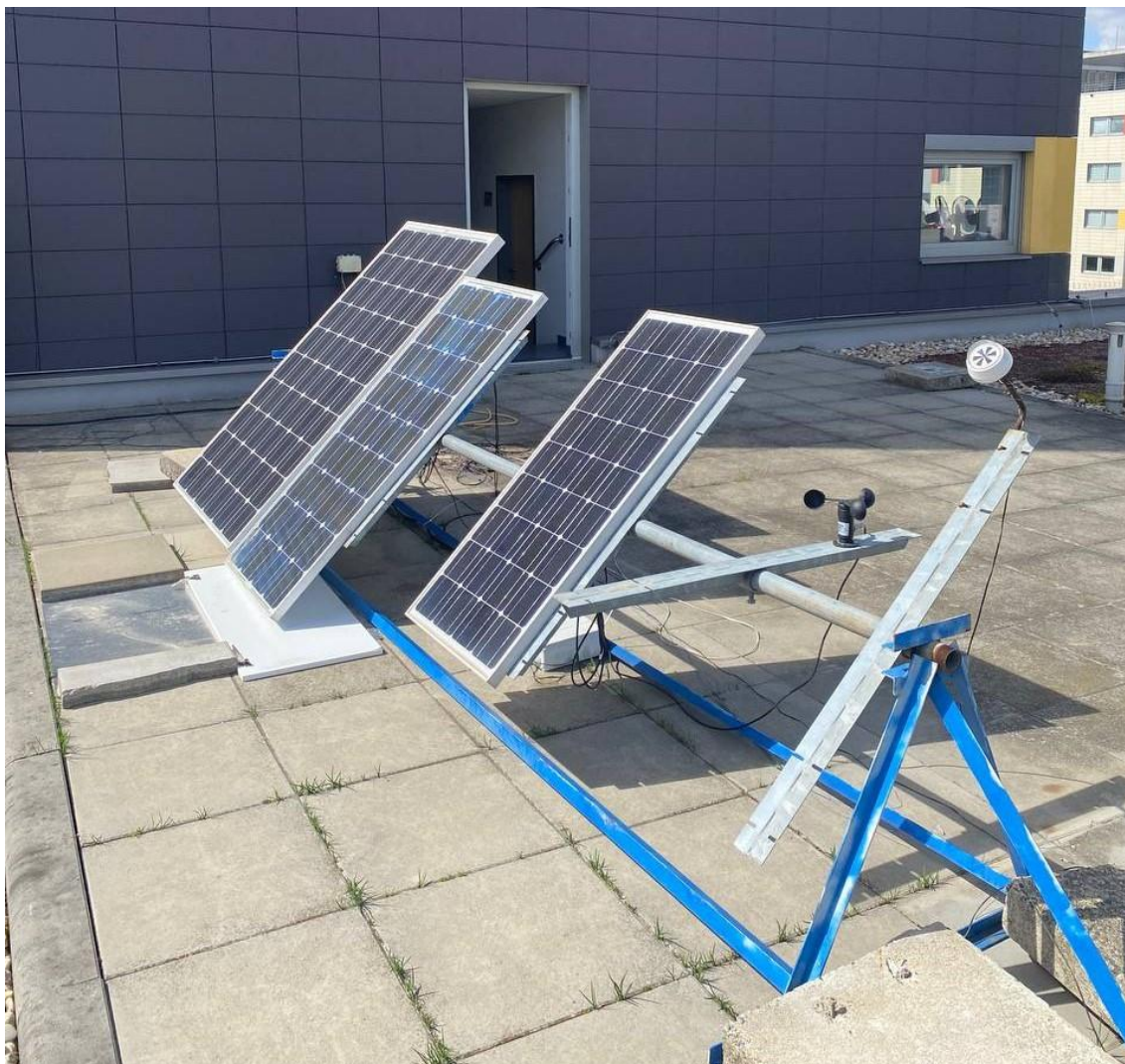
Obrázek 6.12 Pyranometr SG420, na kterém probíhalo měření výkonu dopadajícího slunečního záření. FEKT VUT v Brně 23.03.2022
