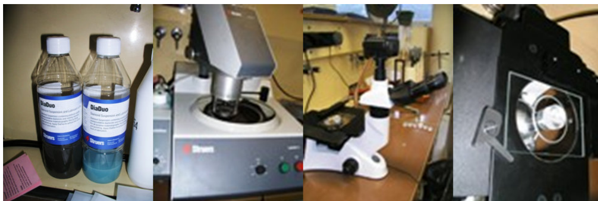
Obr. 2.9 Leštění a kontrola metalografických vzorků
