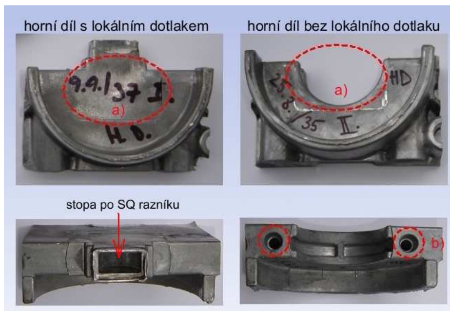
Obr. 2.3 Rozdílný tvar ložiskové oblasti horního dílu starého (s LSC) a nového bloku [2]
