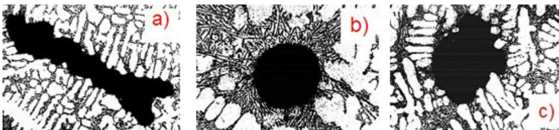
a) mikrostaženina b) plynová bublina c) porezita (kombinace plynu s mikrostaženinou)
