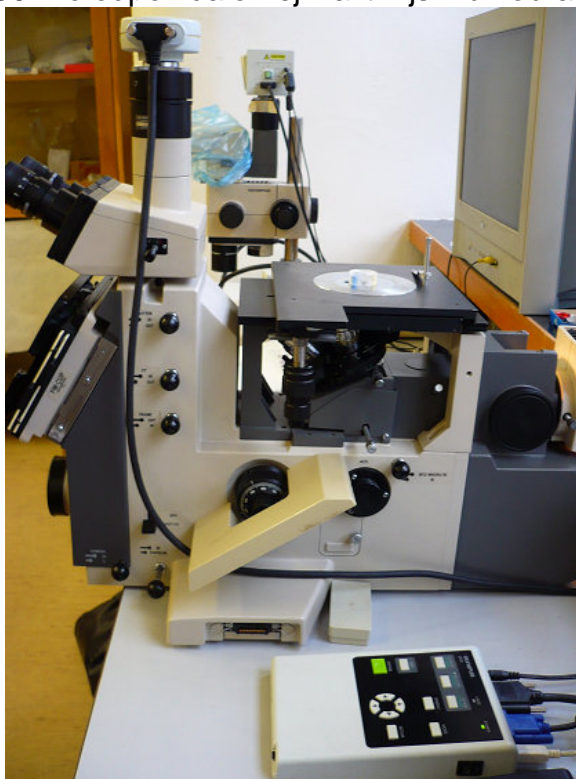
Obr. 2.14 Mikroskop Olympus PMG3 s fotoaparátem Olympus při snímání vzorku
