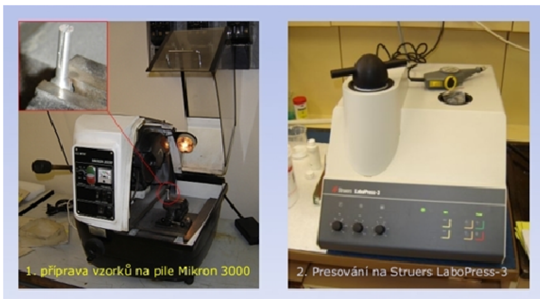
Obr. 2.8 Postup přípravy metalografických výbrusů [2]
