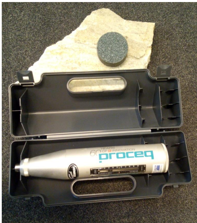
Obr. 2-12: Schmidtovo kladívko typu L s brusním kamenem pro úpravu testovaného povrchu.
