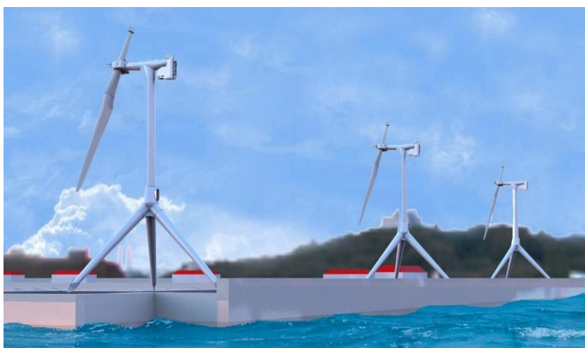
Obr. 4.4 Turbíny s jednou lopatkou[34]
