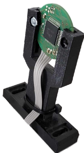
Obrázek 2.2: Fotografie magnetického enkodéru s uchycením
