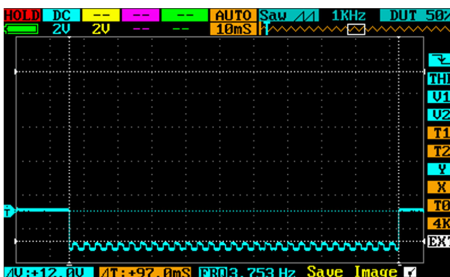
Obr. 49. Printscreen obrazovky ručního multimetru DS203 při měření doby dekódování RS(15,9)
