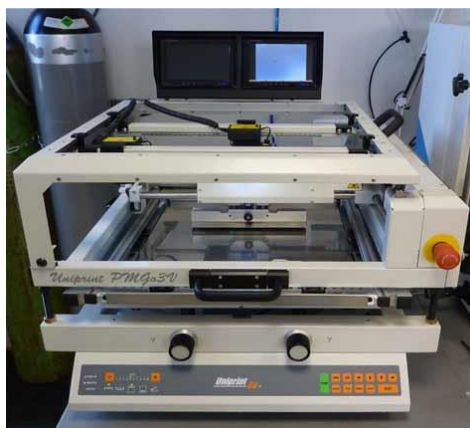
Obr. 7.4: Zařízení Uniprint – PM – Go3 – V pro šablonový tisk.
