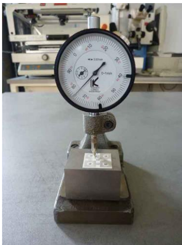
Obr. 7.11: Stojan s úchylkoměrem.
