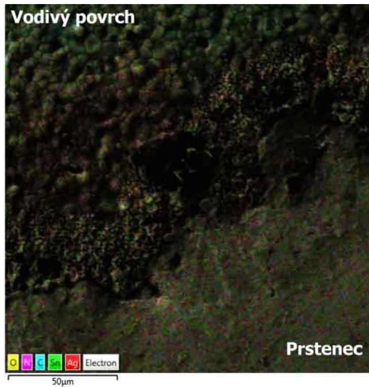
Obr. C.7: EDS, vodivý povrch AgPd, SN100C.
