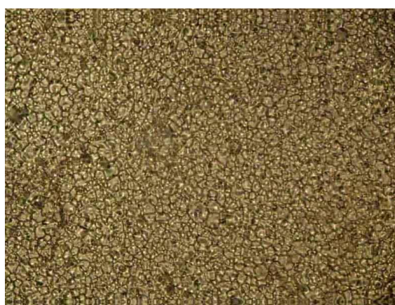
Obr. 3.1: Povrch vodivé vrstvy Ag.
