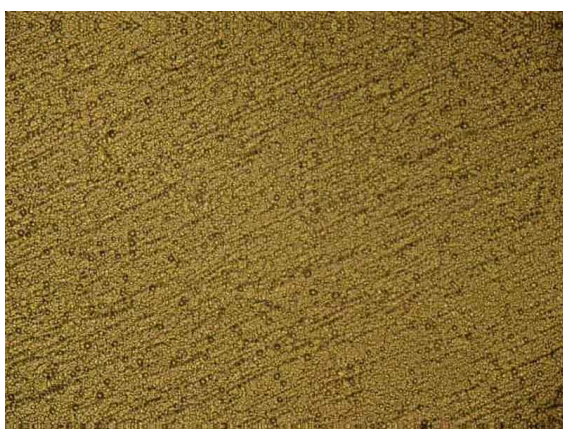
Obr. 3.3: Cu + povrchová úprava ENIG.
