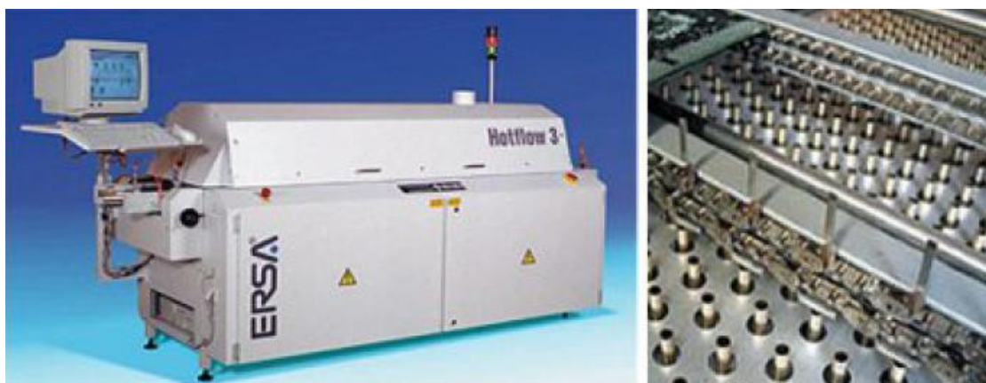
Obr. 6.3: Konvekční pec ERSA a detail trysek [11].
