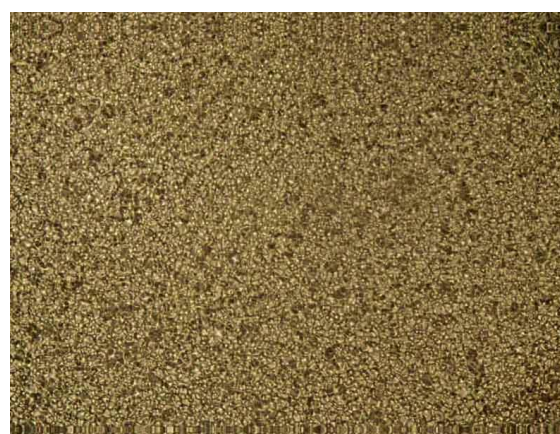
Obr. 3.2: Povrch vodivé vrstvy AgPd.
