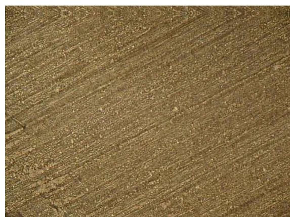
Obr. 3.4: Cu + povrchová úprava imerzní Sn.
