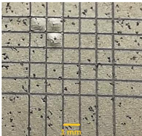
Obrázek č. 20. Struktura povrchu a zobrazení přilnavosti slitiny AZ91 a vytvrzeného Ni-P povlaku.
