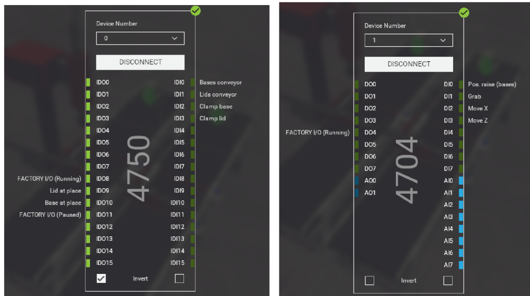
Obrázek 3.11: Schéma zapojení montážní linky
