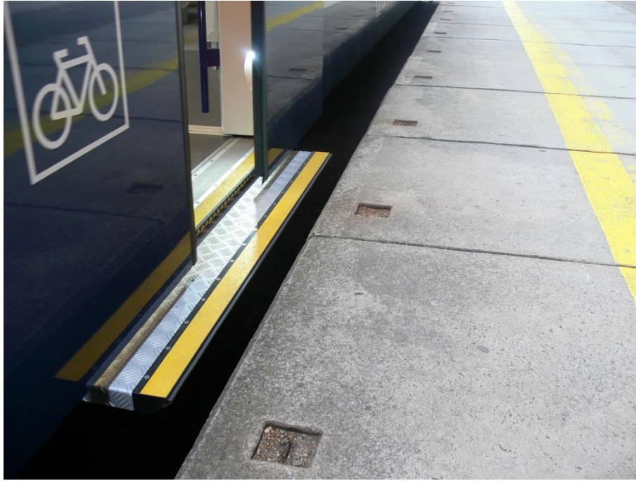
Obrázek 57 Mezera mezi nástupní hranou nástupiště č. 3 a podlahou vozidla (výsuvnou plochou) u koleje č. 1
