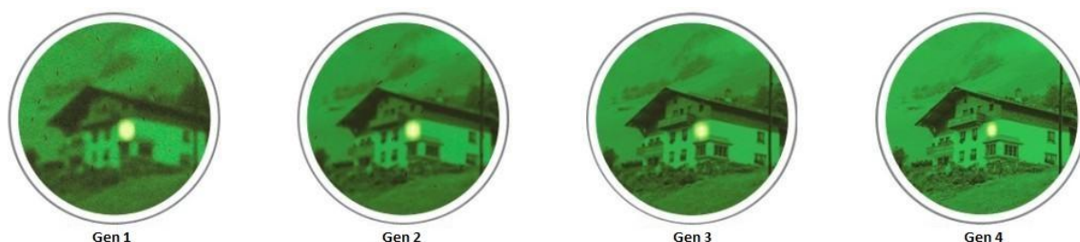
Obrázek 13 - porovnání jednotlivých generací (čistost, jasnost a ostrost sledovaného objektu)
