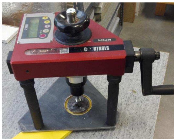
Obrázek 7: Zkušební sestava pro stanovení přilnavosti nátěru odtrhovou zkouškou
