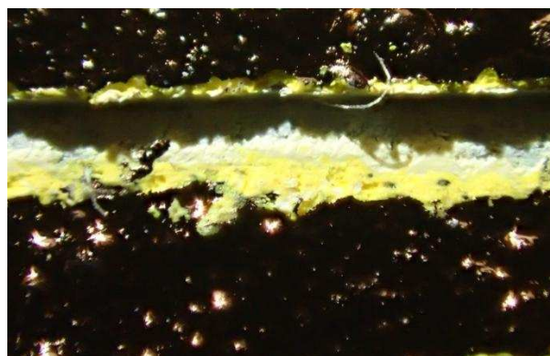
Obrázek 89: Ukázka řezu nátěrem pro zjištění celkové tloušťky
