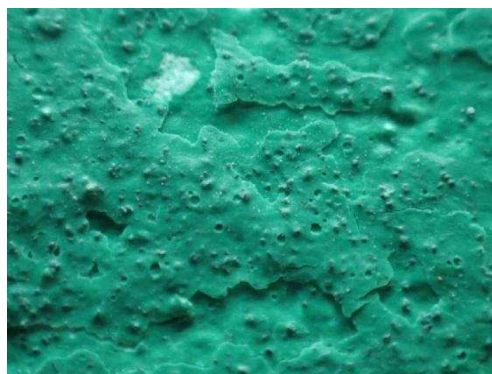
Obrázek 30: Poškození hrany nátěrového systému vzorku Z3PV-M50
