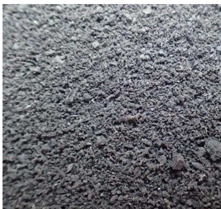
Obrázek 21: Detailní zobrazení plniva PVC
