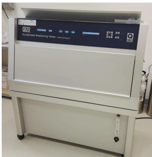
Obrázek 4: QUV komora pro urychlené stárnutí materiálů
