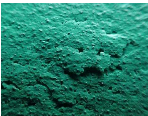
Obrázek 29: Poškození nátěrového systému vzorku Z3PV-M50
