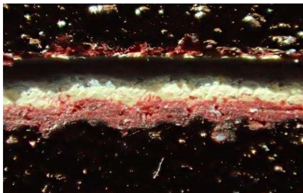
Obrázek 88: Řez nátěrem pro zjištění jeho celkové tloušťky s viditelným přechodem mezi základní a finální vrstvou
