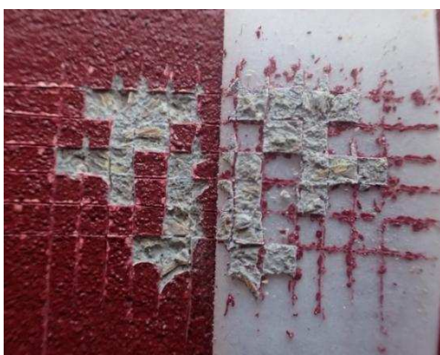
Obrázek 82: Příklad porušení nátěru po mřížkové zkoušce vzorku 2C – M50,Q08
