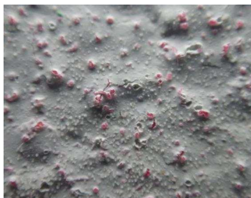
Obrázek 45: Poškození hrany nátěrového systému vzorku S3PE-CH25
