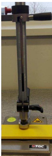
Obrázek 11: Zkušební sestava pro stanovení odolnosti nátěru proti dynamickému zatížení
