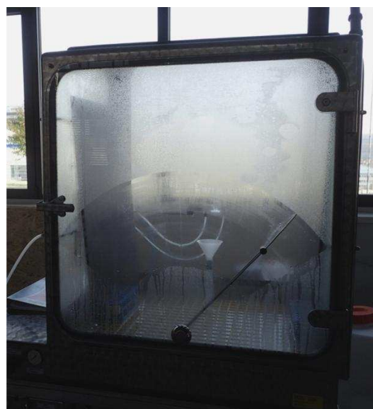
Obrázek 6: Vzduchotěsná komora HK 800 v průběhu testování odolnosti vůči působení \text{SO}_2 (fáze – působení plynu, zvýšené teploty a relativní vlhkosti)
