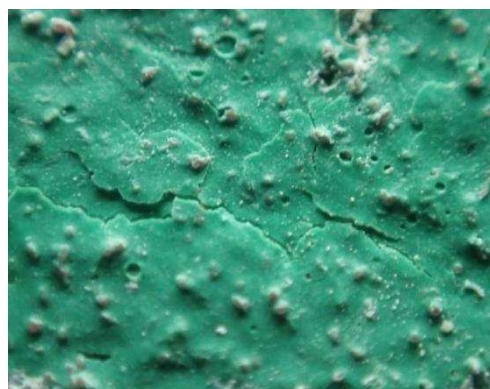
Obrázek 41: Poškození hrany nátěrového systému vzorku Z3PE-CH25
