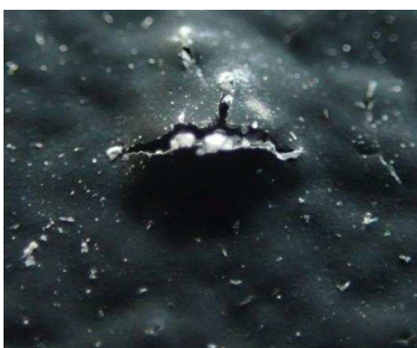
Obrázek 72: Detailní zobrazení nátěrového systému 3S vystaveného \text{SO}_2 po 120 cyklech (patrné prorůstání krystalů skrz nátěrový systém)
