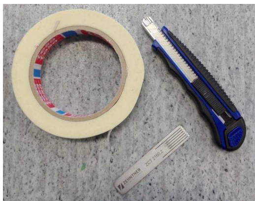
Obrázek 8: Pomůcky potřebné pro mřížkovou zkoušku
