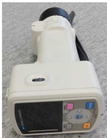
Obrázek 12: Spektroforometr KONICA MINOLTA CM-600d pro měření barevných změn nátěrových hmot
