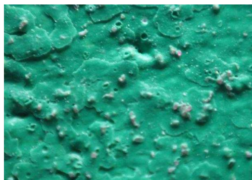
Obrázek 32: Poškození hrany nátěrového systému vzorku Z3PE-M50
