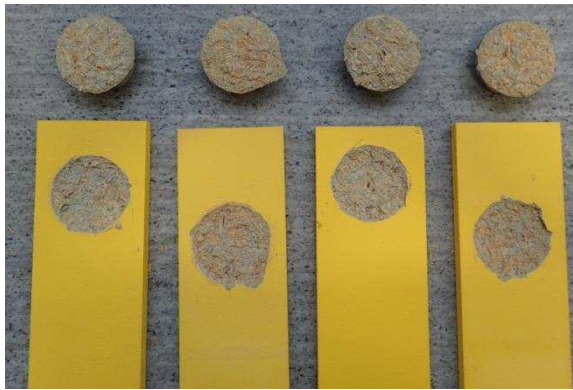
Obrázek 75: Zkušební tělesa zleva 1Z-REF; 1Z-M75,Q12; 1Z-S-REF; 1Z-S-M75,Q12 po provedené odtrhové zkoušce
