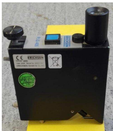
Obrázek 9: Přístroj P.I.G. 455 pro měření tloušťky nátěru
