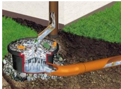
Obr.č. 13 - Filtrační hrnec (zdroj: Dvořáková, 2007a)
