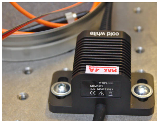
Obrázek 4.4: Dvě varianty zdroje bílého světla – vlevo LED Thorlabs MCWHF1, vpravo LED CREE XP-G2 R5.
